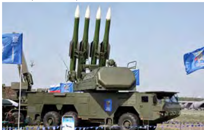
Пусковая установка 5П85ТЕ2 из состава ЗРС С-400 и С-300 © Виталий Кузьмин, www.vitalykuzmin.net
