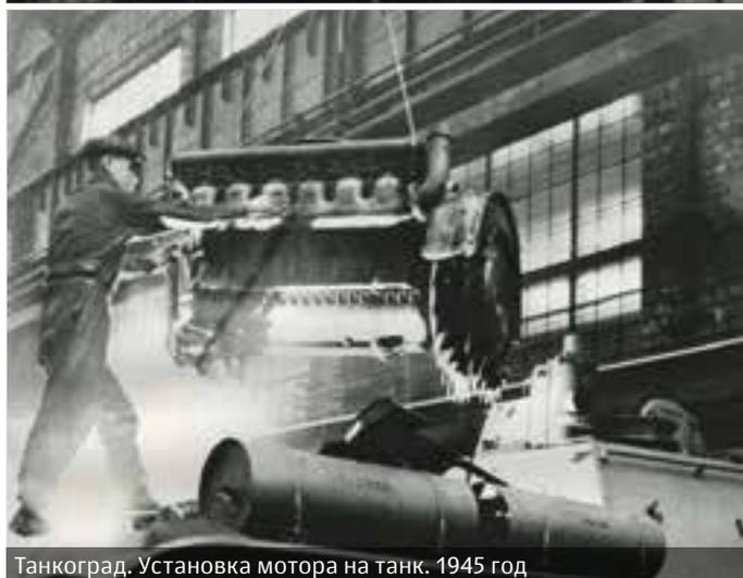
Танкоград. Установка мотора на танк. 1945 год
